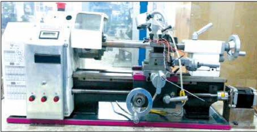
Şekil 1. Durum İzleme Sistemi için tezgâhin algılayıcılarla donatılması
