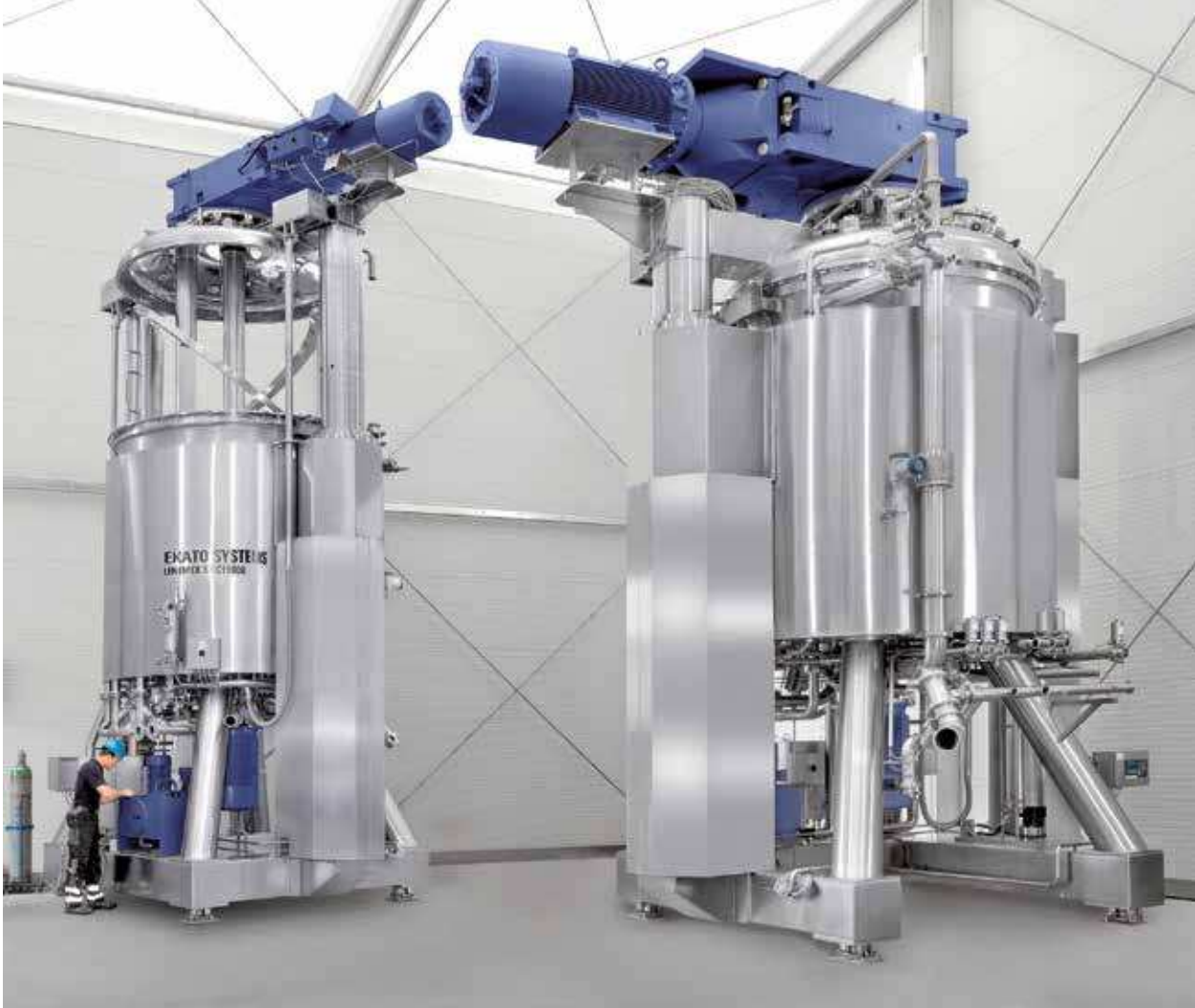
Görsel 1 : NORD endüstriyel redüktörler ile tahrik edilen yeni EKTATO UNIMIX karıştırıcılar: herbiri, 10.000 litre karıştırma kapasitesiyle, tek partide üretim rekoru kırmaktadır
