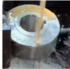
Görsel 8: Tel erezyonda dişli kesme işlemi
