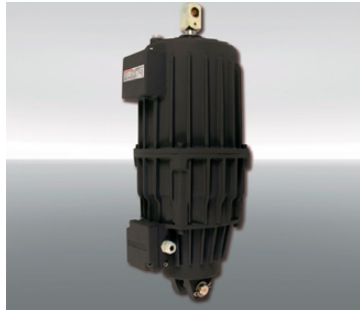
Esneklik: DX 280 FEA, RINGSPANN'ın ürettiği beş farklı tahrik ünitesiyle donatılabilir. Bu tahrikler, 1.700 ila 28.100 N arası frenleme momentleri ve 22,5 ila 80 kN arası sıkma kuvvetleri için uygundur.
