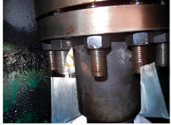
图 2 低速轴漏油点
